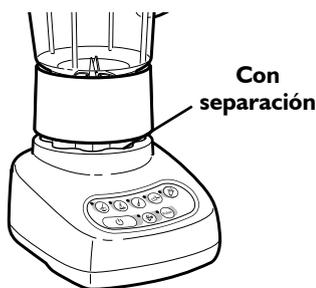
La jarra no está colocada correctamente en el collar de bloqueo, lo que impide el enganche de los acopladores. Retire la jarra de la base y colóquela correctamente en el collar. Presione hacia abajo y gire la jarra a la derecha en el collar de bloqueo hasta que oiga un chasquido. Esto permitirá que la jarra enganche el acoplador. Consulte la sección "Montaje de la batidora".
